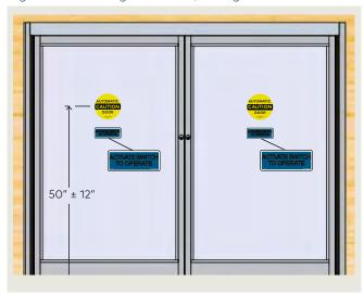
Fig. 9.6.4 Push/pull, door pull, swing side
